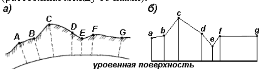
Рис. 7. Вертикальный разрез (а) и профиль (б) местности
